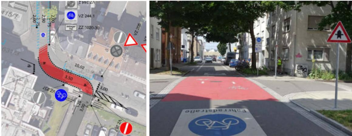
Abbildung 19: Gestaltung einer Fahrradstraße entlang eines Versatzes in Offenbach am Main (links)<sup>42</sup> und bevorrechtigt über einen Knotenpunkt in der Stadt Ulm (rechts)<sup>43</sup>
