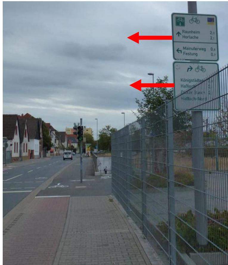
Wegweiser mit Hilfe von Auslegern nach links versetzen, so dass sie nicht vom Zaun verdeckt werden
