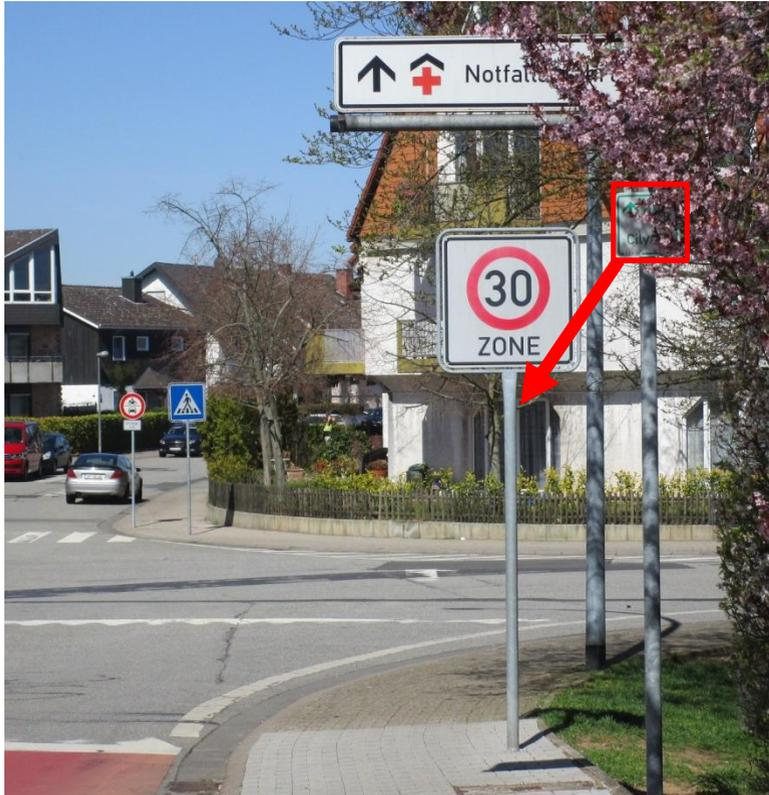
Wegweiser versetzen von Rohrfosten mit Zeichen „Notfallanfahrt“ an Rohrfosten mit VZ „Beginn einer Tempo 30-Zone“
