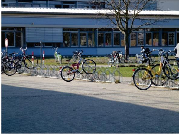
Fahrradparker minderer Qualität ("Felgenkiller", eingeschränkte Sicherung des Fahrrads); keine Überdachung
