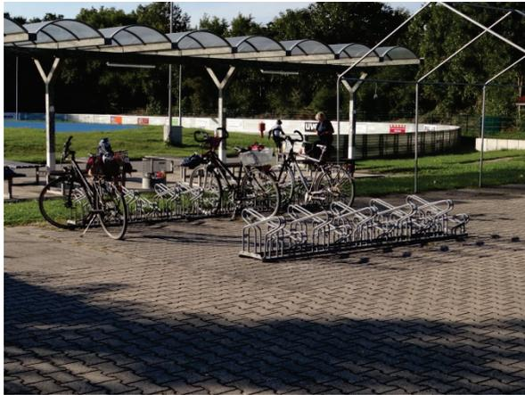
Fahrradparker minderer Qualität ("Felgenkiller", eingeschränkte Sicherung des Fahrrads); etwas abgelegen;
