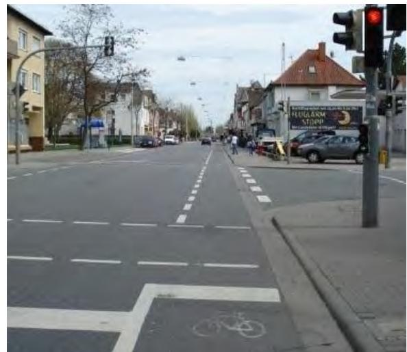
Abbildung 113: Vorfahrt für den Radverkehr an dieser Ampel in Gustavsburg: Die Haltelinie für den Radverkehr ist vorverlegt und die Ampel schaltet früher auf grün als für den MIV.
