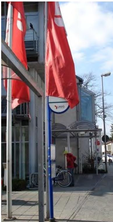
**Abbildung 73:** Dieses Bushaltestellenschild in Goddelau wird fast vollständig durch die Fahnen des benachbarten Geldinstituts verdeckt und büßt dadurch seine Funktion ein.
