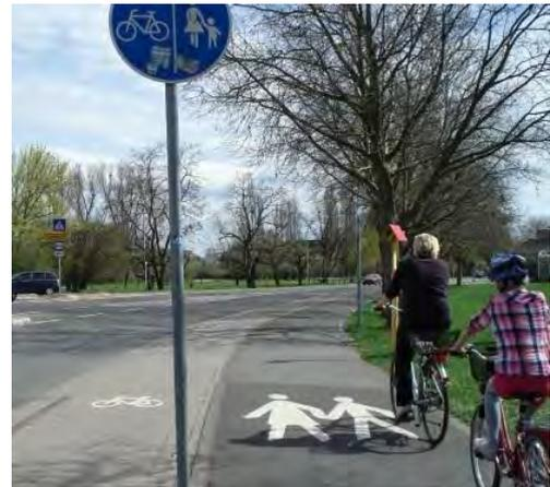
**Abbildung 122:** Der Radweg gepflastert, der Fußweg geteert – dies ist eine Versuchung für Radfahrer, verbotenerweise den Fußweg zu benutzen (Ginsheim).
