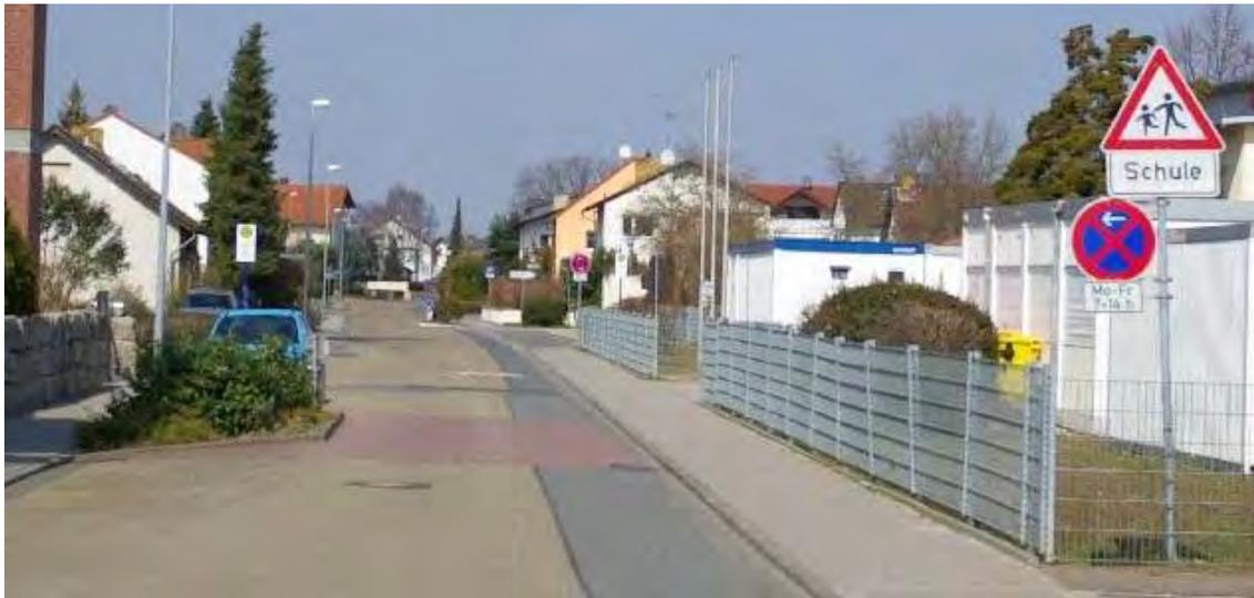
Abbildung 38: Fahrbahnverengung zur Geschwindigkeitsreduzierung vor der Schule in Geinsheim.
