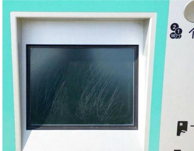
**Abbildung 54:** ...oder ein zerkratztes Display (hier am Bahnhof Wolfskehlen).
