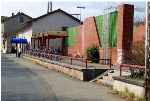
**Abbildung 134:** Diese Bike+Ride-Anlage am Bahnhof Goddelau ist über eine Treppe zugänglich – eine wenig sinnvolle Lösung. Während der hintere Teil der Anlage überdacht ist und Diebstahlschutz bietet, besteht der vordere Teil aus "Felgenklemmern"; diese werden verständlicherweise nicht genutzt.
