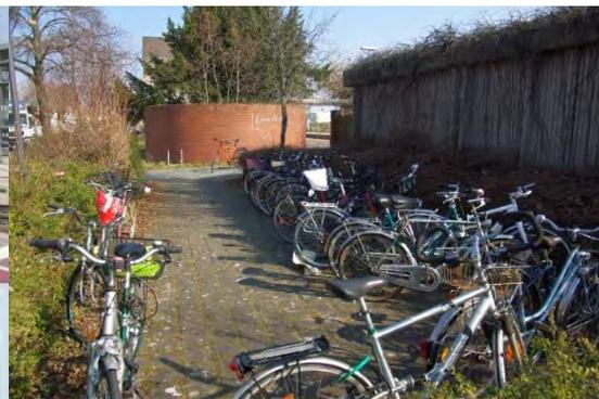
Abbildung 129: Diese Bike+Ride-Anlage am Bahnhof Biebesheim bietet keinen Wetter- und kaum Diebstahlschutz und ist zu klein dimensioniert.
