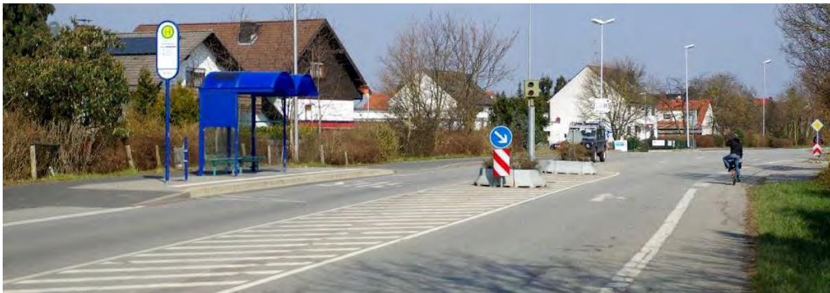
**Abbildung 43:** Gelungenes Beispiel für eine verkehrsberuhigende Straßenraumgestaltung am Ortseingang (hier in Stockstadt): Fahrbahnverengung durch Radfahrstreifen, Bushaltestelle und Mittelinsel, zudem Anlage zur Geschwindigkeitsüberwachung. Die Bushaltestelle ist barrierefrei ausgebaut.
