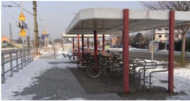
**Abbildung 130:** Gutes Beispiel für eine gelungene Bike+Ride-Anlage: überdachte und vom Bahnhof direkt zugängliche Fahrradständer mit der Möglichkeit den Fahrradrahmen anzuschließen - hier am Bahnhof Nauheim Nordseite...
