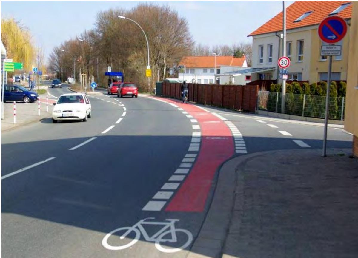
Abbildung 98: Diese Radwegführung in Goddelau ist gelungen: Am Ortsausgang wird der Radverkehr über eine Furt neben der Bushaltestelle auf die andere Straßenseite auf den straßenbegleitenden Radweg außerhalb geführt. Die Bushaltestelle ist zudem so gestaltet, dass sie geschwindigkeitsreduzierend wirkt.
