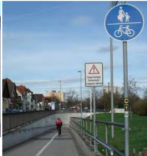
**Abbildung 137:** ...Wesentlich komfortabler die Bahnunterführung in Rüsselsheim. Führungslinien und ein Hinweisschild helfen, zu schnelles Fahren und Zusammenstöße zu verhindern.
