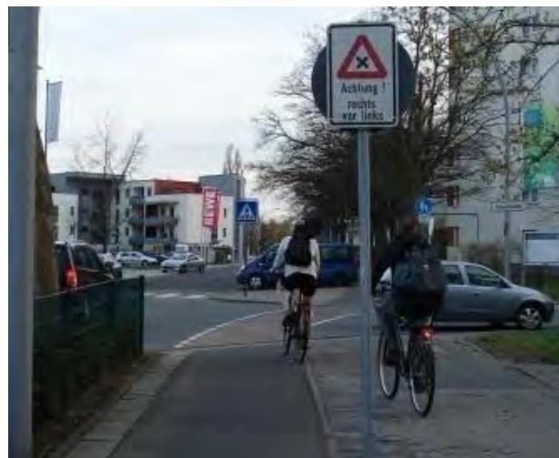
Abbildung 37: ...Gilt dann doch einmal rechts vor links, wird dies per Beschilderung angezeigt. An dieser Kreuzung irritiert besonders die Markierung für den Radverkehr, die fälschlicherweise vermuten lässt, man befinde sich auf einer Vorfahrtsstraße.
